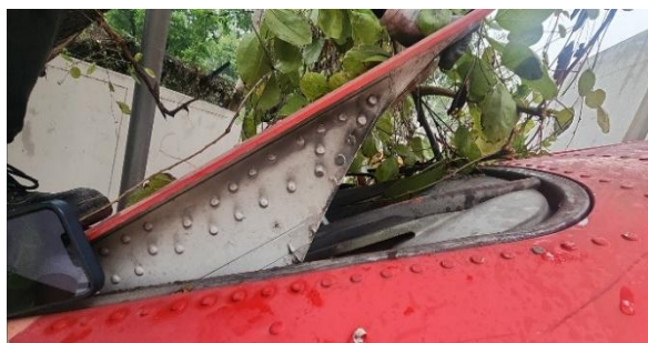
Figure 10 APU Air Inlet Door
